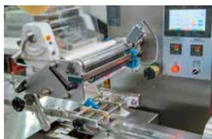
Machine de formage, remplissage et scellage
