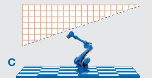
**Will der Manipulator einen definierten Raum verlassen, wird dieser unverzüglich durch die FSU gestoppt! (Unabhängig von der Geschwindigkeit)**
