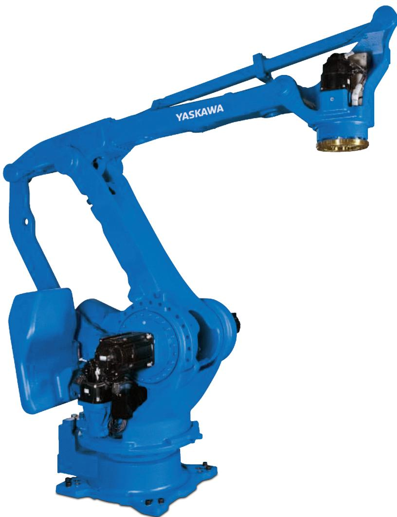
Polyvalent et puissant, le robot MOTOMAN PL500 à 4 axes offre des performances élevées en matière de palettisation de cartons, de caisses et de nombreuses autres tâches logistiques pour l'automatisation des fins de ligne ou des centres logistiques.
