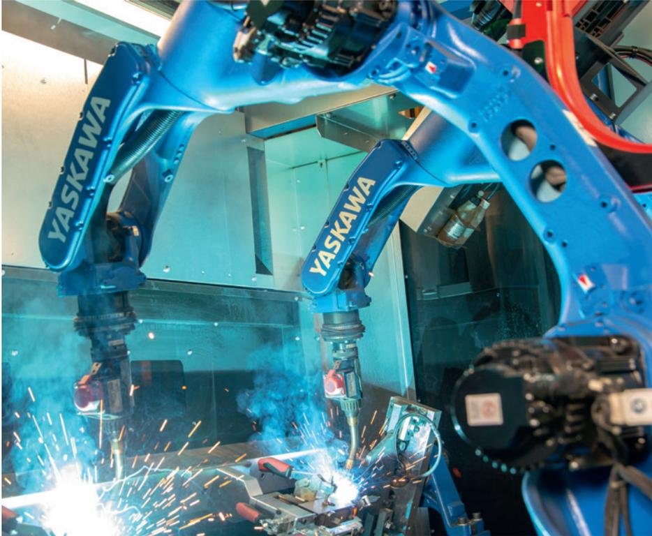
Avec plus de 590 000 robots installés dans le monde, YASKAWA est l'un des leaders mondiaux et français pour les applications de soudage robotisé et propose une très large gamme de robots industriels pour de nombreuses applications. YASKAWA offre tout particulièrement, une gamme de robots dédiée au soudage à l'arc pour les process MIG/MAG/TIG et plasma.
